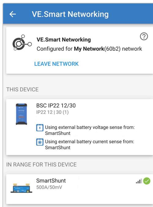
17. Para sistemas con cargadores compatibles con VE.Smart Networking adicionales conectados a la misma batería/bancada de baterías, repita los pasos 8 a 16 anteriores para incluir cada uno de los cargadores que faltan en la misma red VE.Smart Networking.
