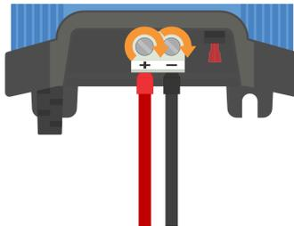
2. Instale un fusible o disyuntor con valor nominal adecuado en el cable de alimentación CC entre el **Blue Smart IP22 Charger** y la batería (o baterías), tan cerca como sea posible de la batería (o baterías). Véase la sección "Instalación > Cableado > Protección de sobrecorriente" para más información.
