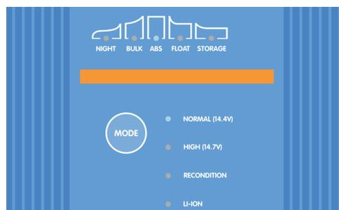
4. Configure el modo de carga y el límite de corriente de carga más adecuados para el tipo y la capacidad de la batería.
