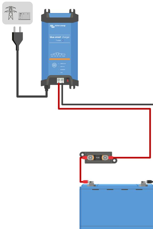
3. Conecte el cable de alimentación CA de **Blue Smart IP22 Charger** a una toma de la red eléctrica. Los LED que indican el modo de carga y el estado de carga actuales se iluminarán transcurridos unos momentos.
