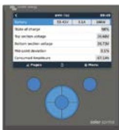
Color Control El potente ordenador Linux que se esconde tras la pantalla de color y los botones recoge los datos de cualquier equipo Victron y los muestra en pantalla. Además de comunicarse con equipos de Victron, el Color Control también se comunica a través de NMEA 2000, Ethernet y USB. Los datos pueden almacenarse y analizarse en el Portal VRM. Hay apps de monitorización y control disponibles para iPhone y Android. https://vrn.victronenergy.com/
