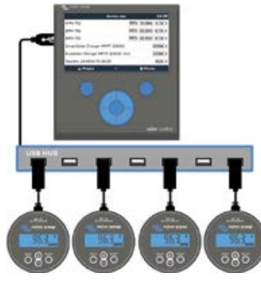
Se pueden conectar hasta cuatro BMV directamente al Color Control. Se pueden conectar incluso más BMV a un concentrador USB para llevar a cabo una monitorización centralizada.
