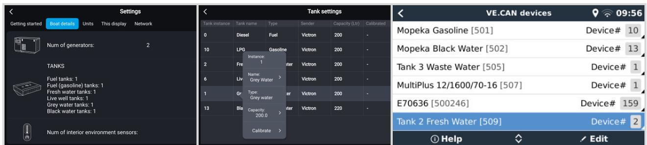
Pulsando brevemente sobre el depósito correspondiente, puede cambiar el depósito por un nombre con significado, que aparecerá entonces en el panel de control.
