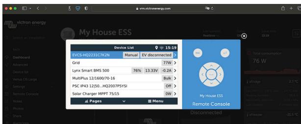
Este método requiere una conexión a Internet operativa, tanto en su teléfono, tableta u ordenador como para el Venus GX. Para una nueva instalación, esto significa que tiene que conectarse con un cable Ethernet.
