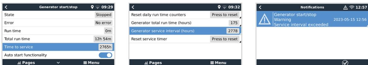
Todos los generadores necesitan tareas de mantenimiento tras un determinado periodo de tiempo. La frecuencia recomendada del mantenimiento de un generador depende en particular de su uso y su tiempo de funcionamiento. Este intervalo de tiempo puede fijarse a través de este menú, que luego inicia un contador que, una vez cumplido el plazo, genera un aviso para indicar que hace falta mantenimiento.
