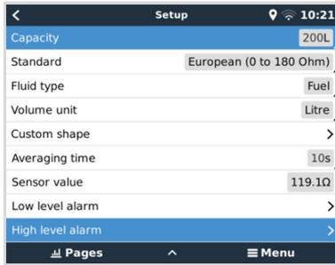
Los sensores se habilitan (y deshabilitan) en el menú I/O (Configuración → I/O → Entradas analógicas) de los ajustes del dispositivo GX. Una vez habilitado, el depósito aparecerá en la lista de dispositivos con opciones para personalizar la configuración y adaptarla a su instalación en particular.
