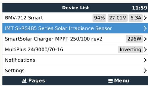
Dentro del menú “Sensor de radiación solar de IMT de la serie Si-RS485”, se mostrarán automáticamente todos los parámetros disponibles (según los sensores conectados), que se actualizarán en tiempo real.
