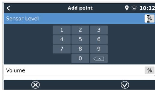
Los puertos del nivel del depósito pueden configurarse para funcionar con las normas de los transmisores de nivel de depósito europeas (0 - 180 ohmios) o estadounidenses (240 - 30 ohmios) o también se puede configurar un rango personalizado de resistencia en ohmios entre 0 y 300 ohmios (se necesita firmware v2.80 o superior).
