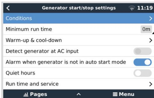
**Condiciones:** El menú de Condiciones determina cuándo debe el generador arrancar y detenerse automáticamente. Véase el capítulo [Condiciones: Parámetros que puede definir el usuario para que se active el arranque/parada automática del generador. \[138\]](#) para más información.
