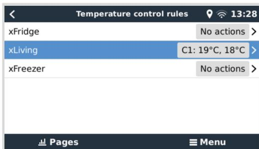
En los productos GX con dos relés disponibles (Cerbo GX, Cerbo-S GX y Ekrano GX), es posible tener un solo sensor de temperatura que controle los dos relés. También se puede tener un solo relé controlado por varios sensores de temperatura diferentes. Por ejemplo, un Cerbo GX con dos calentadores para baterías de litio y que solo usa los dos al mismo tiempo cuando es necesario.
