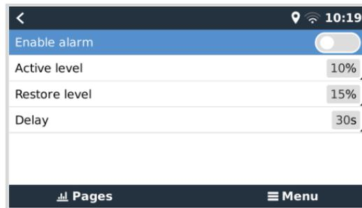
Los datos del nivel del depósito se envían al [portal VRM](#), aparecen en las pantallas de resumen de la embarcación o de la caravana (si están conectadas y activadas) y pueden usarse para accionar el relé, siempre que esté configurado en "Bomba del depósito". Los niveles de los depósitos también pueden monitorizarse en otros sitios dentro del entorno GX:
