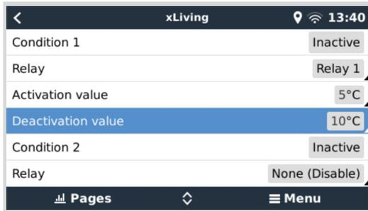
Si esto no es suficiente para mantener la temperatura de la batería por encima de 5 grados, puede que también quiera conectar un segundo contactor de calentador en el relé 2.
