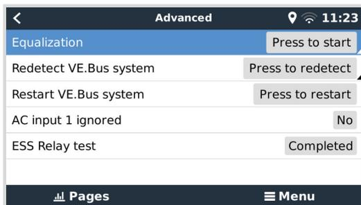
Se puede acceder al Menú avanzado desde Lista de dispositivos → [Multi o Quattro] → Avanzado y contiene opciones para eculización, redetección y reinicio del sistema VE.Bus y muestra el estado de prueba del relé ESS.
