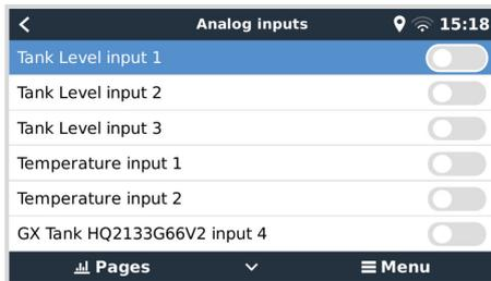
Una vez habilitado, los datos del sensor de temperatura se pueden ver en la lista de dispositivos, y también conectado a VRM.
