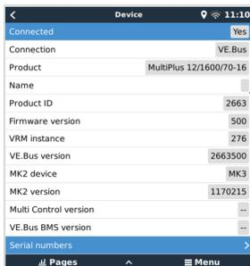
El menú del Dispositivo (Lista de dispositivos → [Multi o Quattro] → Dispositivo) contiene parámetros relativos al dispositivo como creación de un nombre personalizado, versión de firmware, números de serie (en el submenú) y otros elementos que pueden usarse para hacer diagnósticos.
