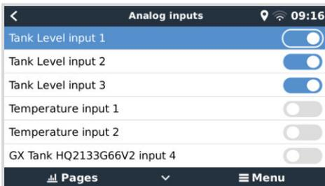
2. En Lista de dispositivos → Entrada de depósito → Dispositivo → Nombre, asigne a cada entrada de depósito un nombre adecuado y único. Por ejemplo, Agua potable 1, Aguas grises SB, Puerto diésel Port, etc.
