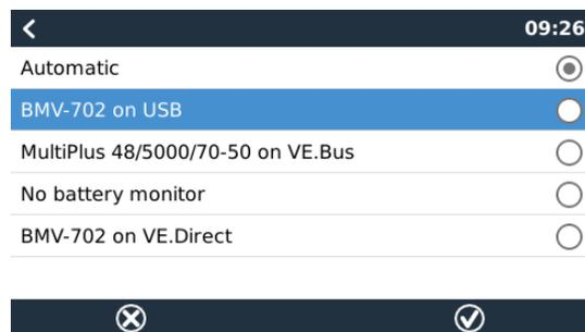
(Configuración → Configuración del sistema → Monitor de la batería)
