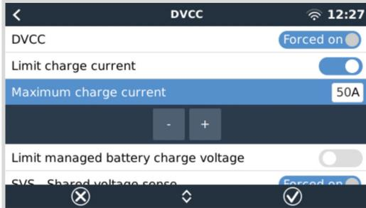
El límite de corriente de carga es un ajuste de corriente de carga máxima configurable por el usuario. Funciona en todo el sistema, de tal modo que se da prioridad automáticamente a los cargadores solares y luego al cargador de baterías CC-CC Orion XS y a continuación al inversor/cargador.
