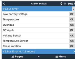
Se puede acceder a la página de Seguimiento del estado de alarma desde Lista de dispositivos → [Multi o Quattro] → Estado de alarma. Muestra información de diagnóstico de parámetros específicos para ayudar a resolver problemas y proporciona información adicional sobre el [error 8/11 del VE.Bus](#).
