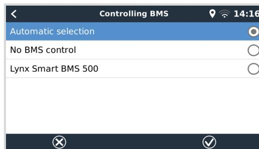
En sistemas con varios BMS conectados, esto permite elegir el BMS que se usará para DVCC. Esto también permite usar un BMV o SmartShunt para hacer un seguimiento del estado de carga seleccionando un BMV como monitor de baterías (Configuración → Configuración del sistema) mientras el BMS se sigue usando para DVCC.
