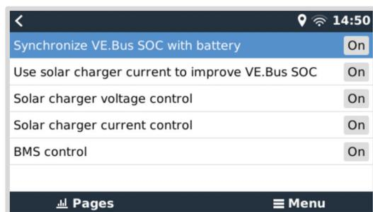
El menú de Estado del sistema (Configuración → Configuración del sistema → Estado del sistema) contiene indicaciones de diagnóstico que pueden ser útiles para diagnosticar problemas del sistema. Tenga en cuenta que aquí no puede configurarse nada. La indicación on/off depende de cómo esté configurado el sistema y de qué dispositivos contenga.
