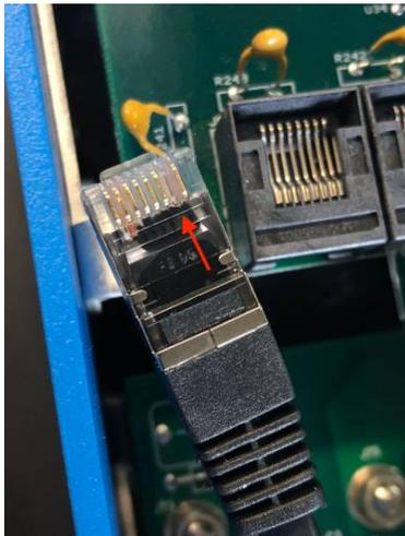
El inconveniente de cortar el pin 7 es que apagar el dispositivo VE.Bus será menos eficaz: aunque dejará de cargar e invertirá, seguirá en modo reposo y por lo tanto extraerá más corriente de la batería que si se hubiera dejado el pin 7. Normalmente, esto solo es relevante en sistemas marino o de automoción, en los que es habitual apagar el dispositivo VE.Bus regularmente. En estos sistemas, le recomendamos que no corte el pin 7 y que simplemente alimente el VGX desde la batería.
