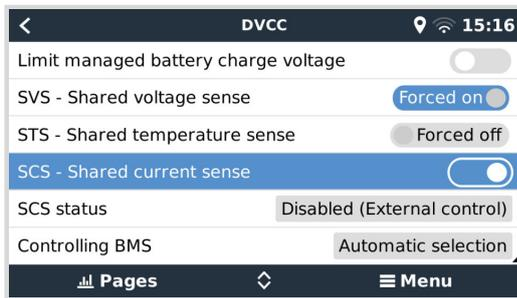
Esta función envía la corriente de la batería, medida por un monitor de batería conectado al dispositivo GX, a todos los cargadores solares y cargadores de batería CC-CC Orion XS conectados.
