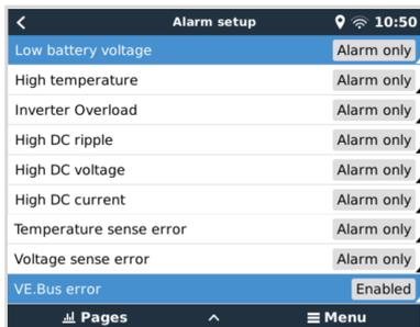
Cuando se usa un sistema VE.Bus, se puede configurar el nivel de gravedad de los problemas del sistema VE.Bus que debería mostrar una notificación en el Venus GX (y hacerlo pitar):
