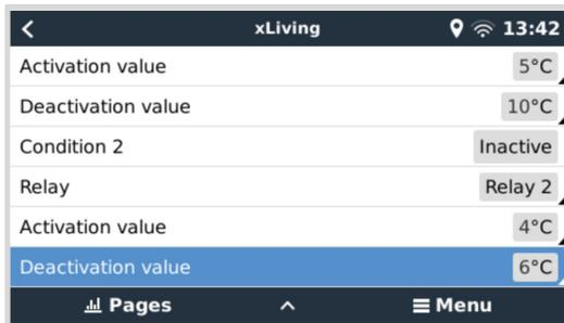
Esto significa que el relé 1 estará activo si la temperatura de la batería cae por debajo de 5 grados. Si la temperatura sigue bajando por debajo de 5 grados hasta 4 grados, se activará el segundo calentador a través del relé 2. Si esto es suficiente para volver a subir la temperatura a 6 grados, el relé 2 se desactivará y el relé 1 permanecerá activo hasta que la temperatura de la batería vuelva a 10 grados.
