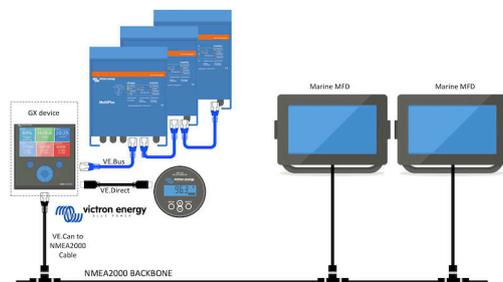
Los dispositivos GX de Victron Energy cuentan con una función de salida NMEA 2000. Si está habilitada, el dispositivo GX actúa como un puente: hace que todos los monitores de baterías, inversores/cargadores y demás productos conectados al dispositivo GX estén disponibles en la red NMEA 2000.
