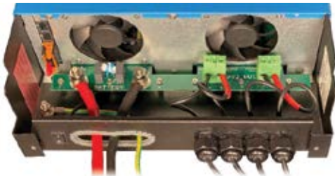
Interior del MPPT RS SmartSolar 450|100
